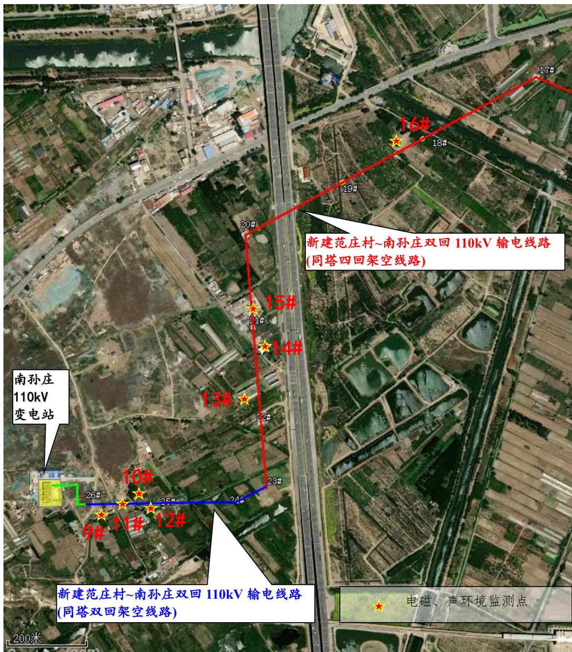
图 7-2 输电线路电磁、声环境敏感目标监测点布点示意图
