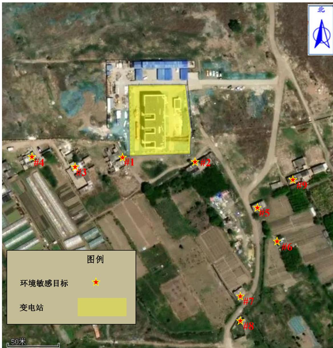
图 2-3 变电站周边电磁、声环境敏感目标分布一览图
