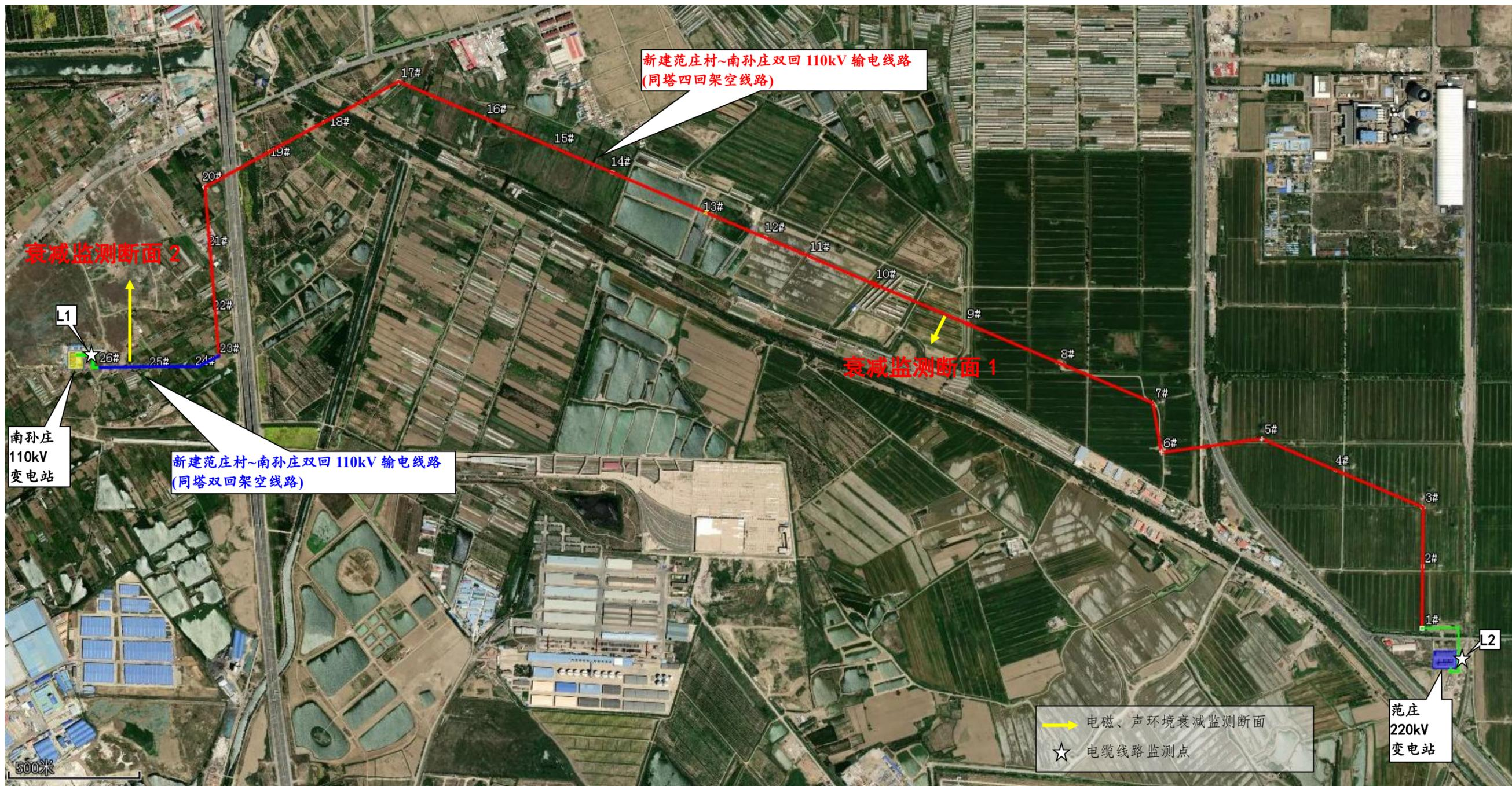
图 7-3 输电线路电磁、声环境衰减监测断面及电缆线路监测点布点示意图
