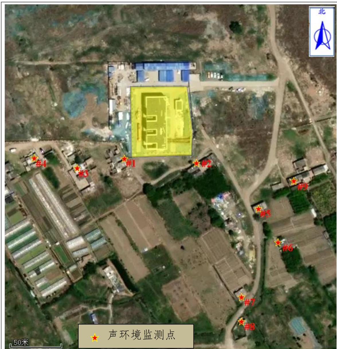
图 7-5 变电站周边环境敏感目标声环境监测布点示意图
