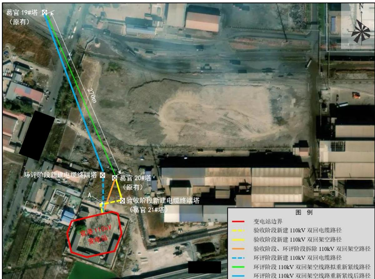
图 4-4 本项目输电线路路径变动图
