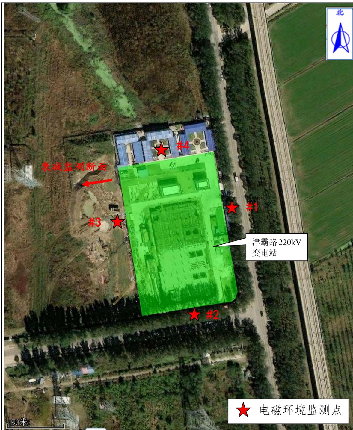
图 7-1 变电站站界电磁环境监测布点示意图
