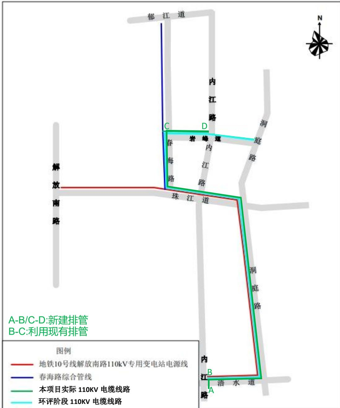
图 4-3 本项目输电线路实际路径与环评阶段路径对比图
