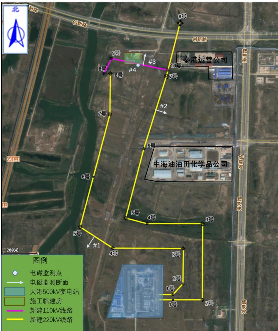
图 7-1 输电线路电磁环境监测布点示意图
