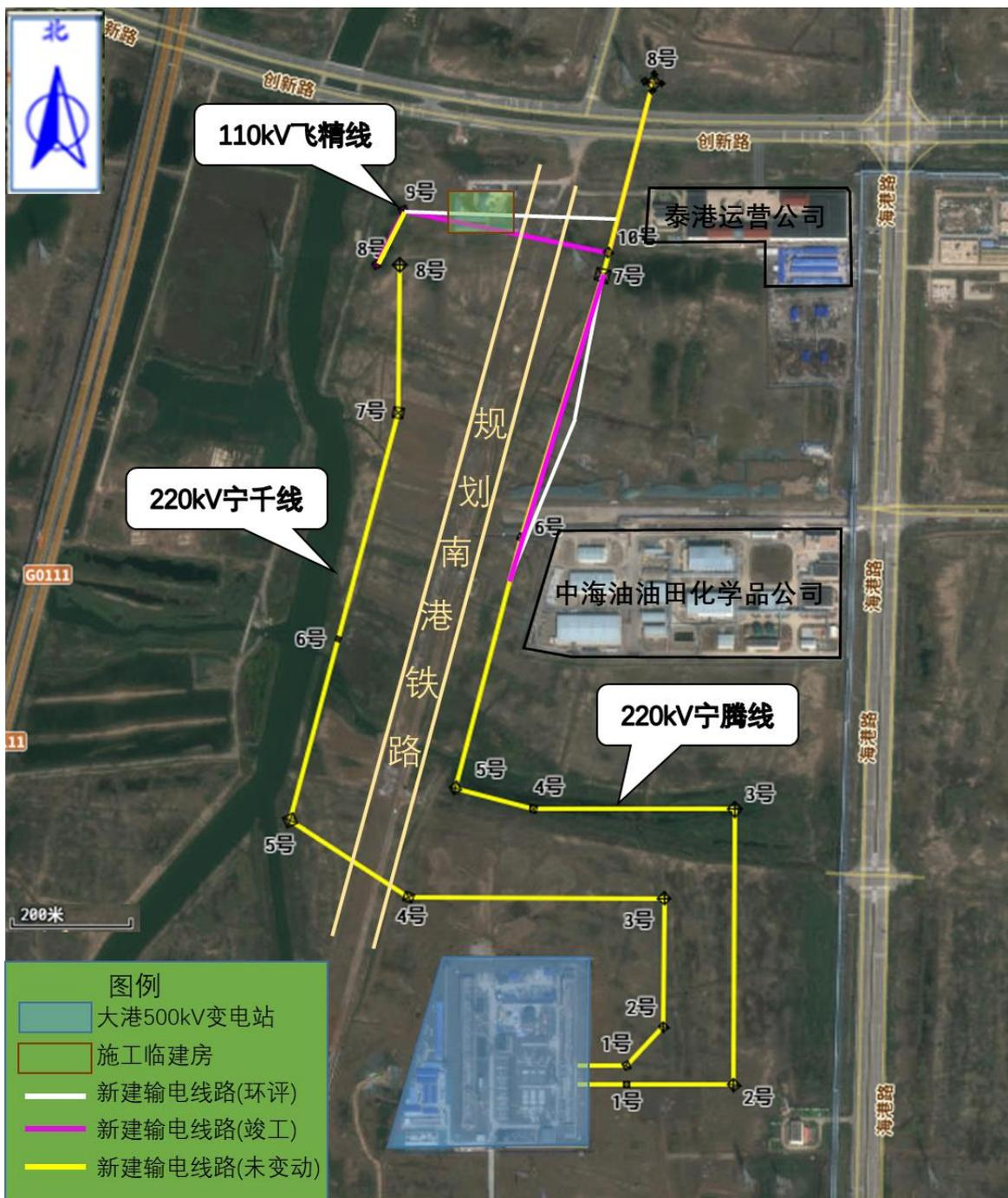
4-4 本工程线路路径图(实际建设)
