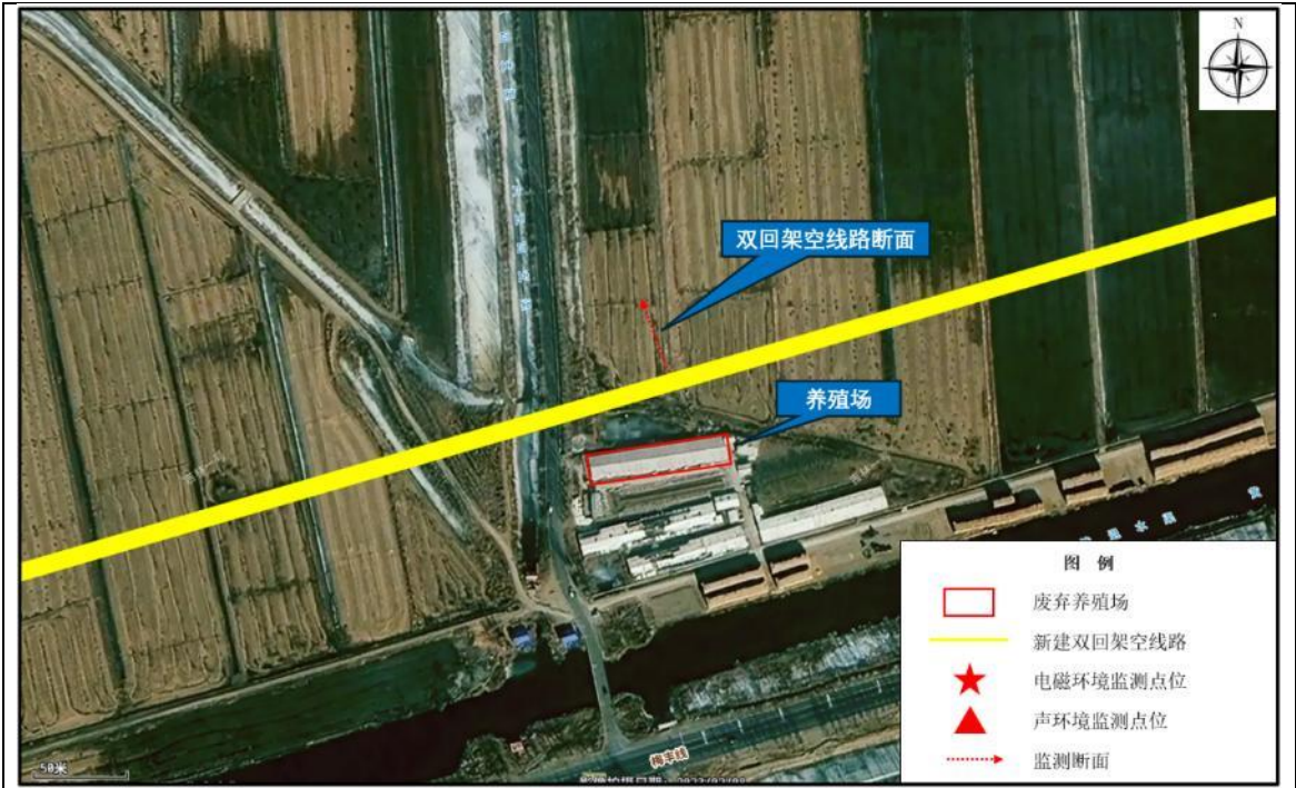
图 7-8 输电线路衰减断面电磁环境监测布点示意图
